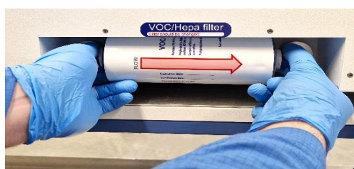
Rysunek 12.2 Procedura montażu i demontażu filtra LZO/HEPA
