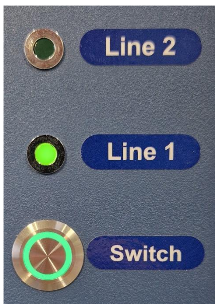
Rysunek 20.2 Przełącznik zmiany wiersza na wielokomorowym inkubatorze do IVF MIRI® TL12 oraz włączony wiersz nr 1
